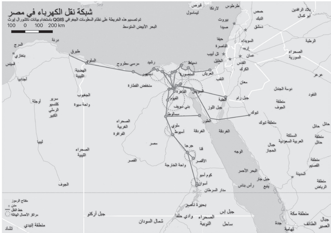
الشكل ٤-٨ شبكة نقل الكهرباء في مصر تُبين مراكز الأحمال الرئيسية
